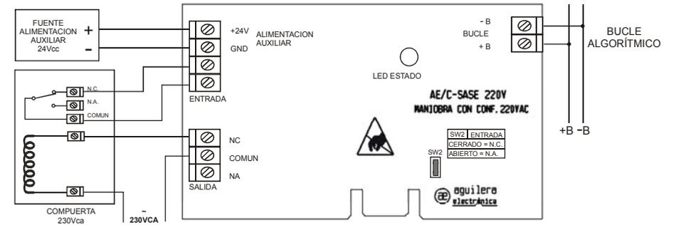
En los dos ejemplos se ha representado una compuerta que necesita estar continuamente alimentada. Si se desea conectar una compuerta que necesita tensión para cerrarse, hay que la electroválvula en el contacto NA de la salida del módulo. Se está controlando en reposo el contacto normalmente cerrado del final de carrera de la compuerta. Para este caso hay que configurar el selector SW2 en posición cerrado = N.C., es decir con el selector SW2 puesto.
