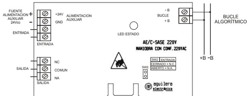
Este módulo requiere tensión de alimentación de 24Vcc para la actuación de la salida.
