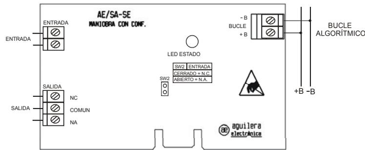
**ATENCIÓN:** La conexión de la salida de relé de los módulos a cargas inductivas, como por ejemplo retenedores de puertas o compuertas de aire acondicionado, debe ir protegida mediante un diodo 1N4001 o similar. La conexión de este diodo se debe realizar en las mismas bornas de la bobina. Si los retenedores disponen de pulsador de desbloqueo el diodo se debe colocar después del pulsador en bornas de la bobina.
